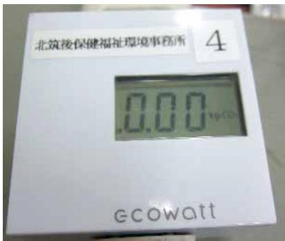
コンセントと電気器具の間に差し込んで消費電力や電気代、CO<sub>2</sub>排出量を測定できるエコワットを使用し、電気の使用状況の調査を行っています。
