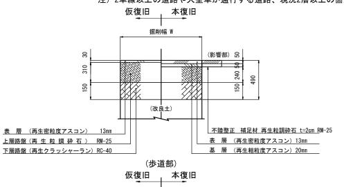
掘削幅W (影響部) 9 (160) (改良土) 表 層 (再生密粒度アスコン) 13mm 補足材 再生粒調砕石 t=2cm RM-25 路 盤 (再生クラッシャーラン) RC-40 表 層 (再生密粒度アスコン) 13mm
